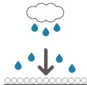
表層の石粒が鋼板の雨粒を細かく拡散させる性質があり、うるさい原因の“共鳴”を抑える機能があります。
