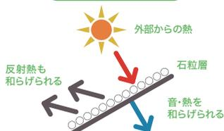
表層の石粒が基材の鋼板を熱や赤外線から守り、断熱性に優れた性能を発揮します。
